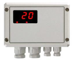
Zur bedarfsgerechten Steuerung der Ventilatoren setzen Sie unsere Warmluftrückführungs-Regelung 03.431 ein. Das Gerät erfasst mit zwei Fühlern die Temperatur in Decken- und Bodennähe um nach der Temperaturdifferenz die nachgeschalteten Drehzahlregler und Ventilatoren ein und aus zu schalten.
